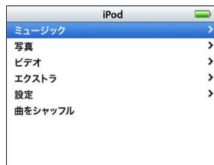
クリックホイールと「センター」ボタンを使用すると、画面のメニューの操作、曲の再生、設定の変更、および情報の表示を行うことができます。クリックホイール内を親指で軽く触れて動かして、メニュー項目を選択します。項目を選択するときは、「センター」ボタンを押します。前のメニューに戻るときは、クリックホイールの「メニュー」ボタンを押します。
