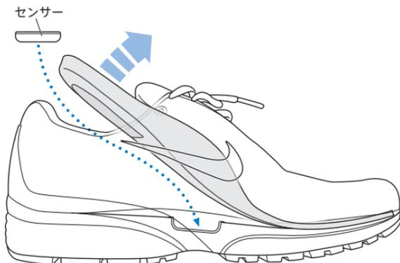
ワークアウトをしないときでもセンサーをシューズに取り付けたままでかまいません。ただし、長期間ワークアウトをしないで、普通にシューズを履く場合は、バッテリー寿命を節約するためにセンサーをフォームと入れ替えてください。
