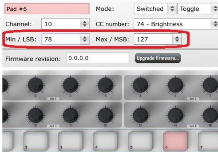
La première pression du Pad 1 enverra une commande CC# 74 avec une valeur de 78, qui fermera le filtre mais laissera passer une grande partie du signal audio au travers. La deuxième pression du Pad 6 enverra une valeur de 127, ouvrant le filtre complètement.
