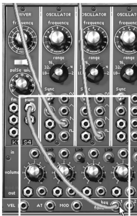
Connexion du PWM sur l'entrée du suivi de clavier 1 (key follow1)
