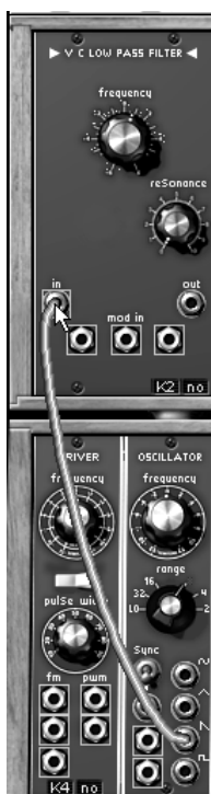
Connexion entre l'oscillateur 1 et le filtre1
