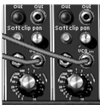
Le câblage vers les deux VCA
