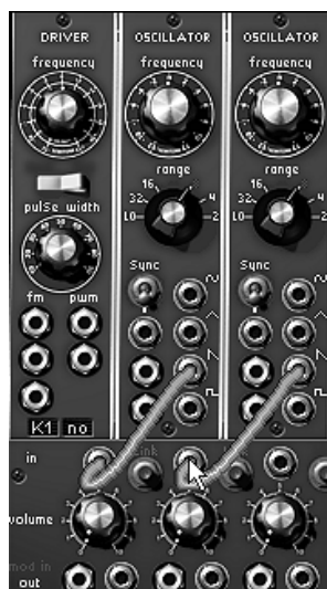
Câblage des oscillateurs vers le mixeur
