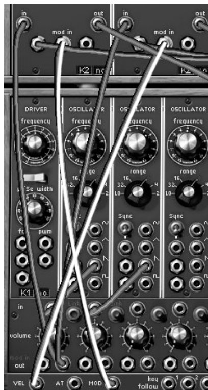
Connexions des sorties de modulation et de vélocité sur la modulation de fréquence des filtres 1 et 2
