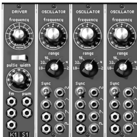
Une banque d’oscillateurs : 1 « driver » et 3 « oscillateurs esclaves »
