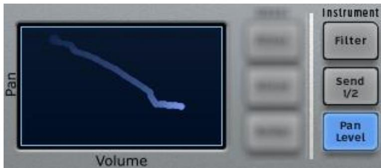
Le bouton d'effet d'instrument Pan / Level vous permet de contrôler la position stereo et le volume d'un seul instrument contenu dans un kit. Si vous voulez déplacer le son d'un charleston fermé (closed hi hat) depuis la gauche du mix vers la droite, par exemple, appuyez sur Select + Instrument pad 3 puis appuyez sur le bouton Pan / Level. Ensuite, utilisez le Pad d'effets en temps réel pour placer le charleston fermé où vous voulez qu'il soit dans le champ stéréo.
