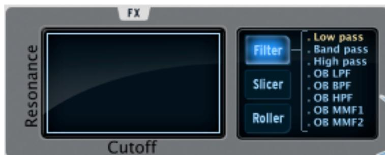
Le bouton Filter met à votre disposition un filtre Low pass (passe-bas), Band Pass (passe-bande) et High pass (passe-haut), Filtres Oberheim grave, aigu, passe bande, avec fréquence de coupure et résonance.
