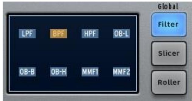
Le bouton *Filter* met à votre disposition un filtre Low pass (passe-bas), Band Pass (passe-bande) et High pass (passe-haut), Filtres Oberheim grave, aigu, passe bande, avec fréquence de coupure et résonance.
