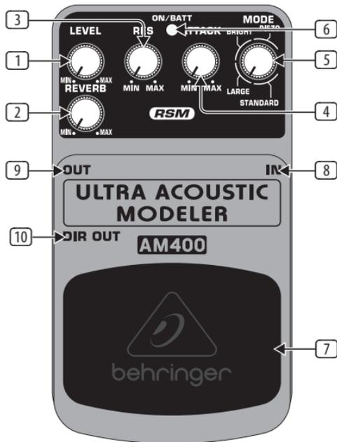
Das **BATTERIEFACH** befindet sich unter dem Fußschalter. Um die Batterie (nicht im Lieferumfang enthalten) einzubauen oder auszutauschen, drücke die Gelenke vorsichtig zusammen und entferne das Pedal. Achte darauf, das Gerät nicht zu zerkratzen.
