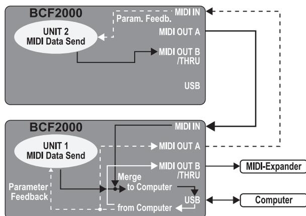
Diese Betriebsart sollten Sie wählen, wenn Sie zwei B-CONTROLS koppeln möchten, um mit beiden Ihre Software über einen gemeinsamen USB-Port zu steuern. Zusätzlich kann MIDI OUT B des ersten Controllers (Unit 1) als 16-kanaliger MIDI-Ausgang vom Rechner aus genutzt werden. Die Daten beider B-CONTROLS werden gemischt und via USB zum Host-Rechner geschickt. Für Unit 2 sollten Sie **Stand Alone-Mode 3** wählen.
