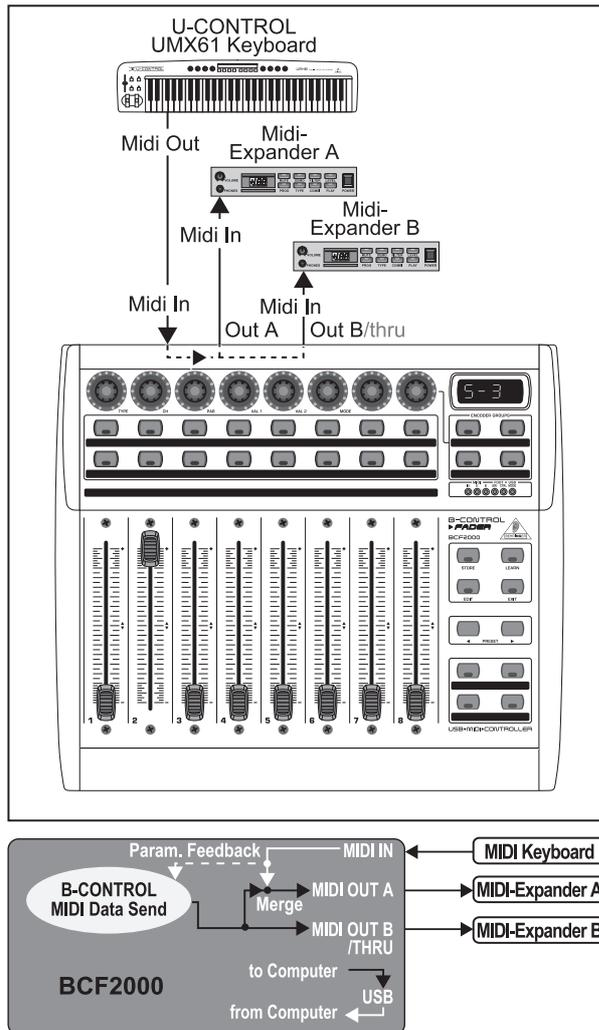
Abb. 4.7: Anwendung und Routing im Stand Alone-Mode 3
