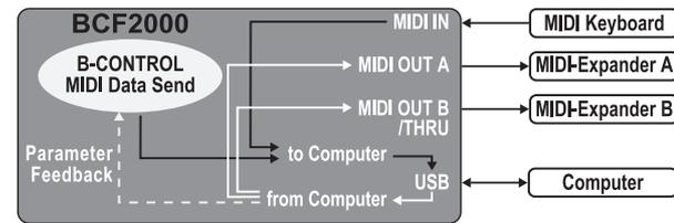
Abb. 4.3: Routing und Anwendung im USB-Mode 3
