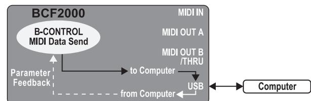
Abb. 4.1: Routing und Anwendung im USB-Mode 1
