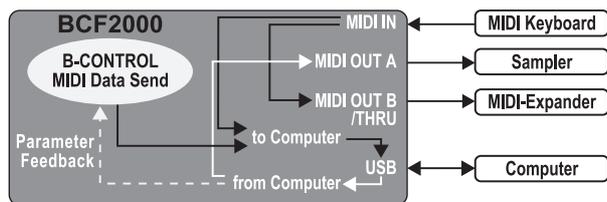
Abb. 4.2: Routing und Anwendung im USB-Mode 2
