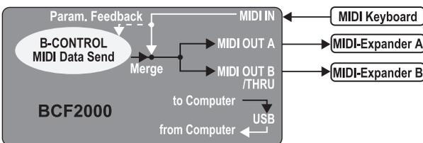
Abb. 4.5: Anwendung und Routing im Stand Alone-Mode 1
