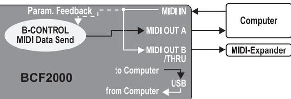
Abb. 4.8: Anwendung und Routing im Stand Alone-Mode 4
