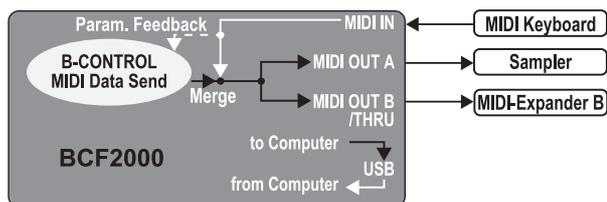
Abb. 4.6: Anwendung und Routing im Stand Alone-Mode 2
