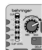
**6** マイクホンが直接 XLR INPUT に接続されている場合、CLIP LEVEL ノブを中央 (12 時の位置) に設定します。マイクホンに入力しながら、入力感度を MIC GAIN ノブで調整します。CLIP LED が点灯しないようにします。
