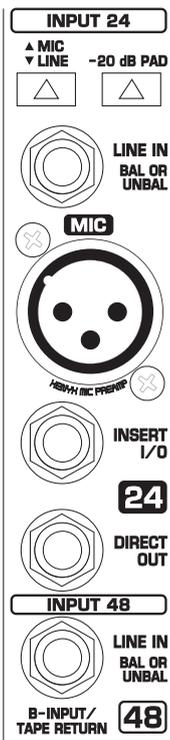
Fig. 7.8: Secção de entrada dos canais A e B
