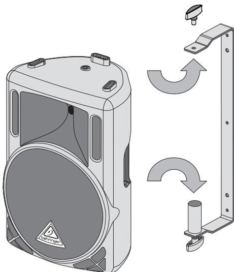
Abb. 1: Lautsprecher in Halterung einsetzen
