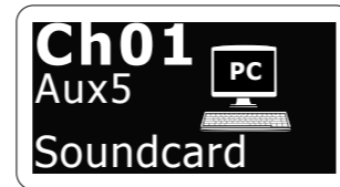
Beispiel: Kanal 1 trägt den Kurznamen ‚Soundcard‘ und wird über Aux-Eingang 5 gespeist
