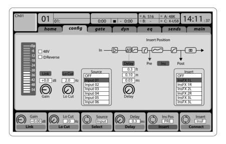
输入通道 1-16 可被预配置以使用本机输 入信号 1-16. 但也可以将它们分配以使用 音频引擎上的任何其它可用信号,包括混 音母线 / 子编组输出信号。在 Preamp Config 页面可改变通道源。
