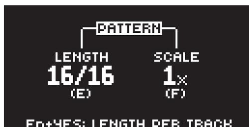
**LENGTH** steuert die Länge der Steps des Pattern. Die Zahl links außen zeigt die Anzahl der Steps im Pattern an. Die durch die zweite Zahl festgelegte Gesamtlänge bestimmt die maximal verfügbare Anzahl Steps im Pattern. Ein Pattern kann entweder 16, 32, 48 oder 64 Steps haben. Wenn Sie 17 Steps oder mehr in einem Pattern verwenden, wird der Taster **[PAGE]** (im GRID RECORDING Mode) verwendet, um zwischen den verschiedenen Patternseiten hin- und herzuschalten.
