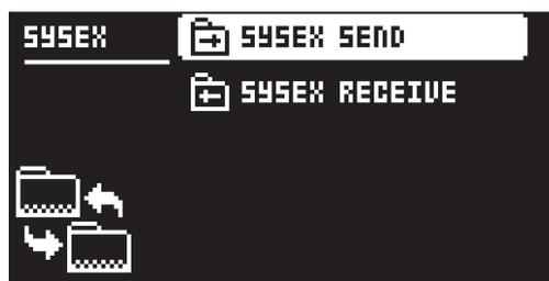
Beim Empfang oder dem Versand von SysEx-Daten müssen die MIDI-Buchsen oder der USB-Port des Digitone mit dem externen sendenden / empfangenden Gerät verbunden werden.
