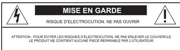
Le symbole de l'éclair à l'intérieur d'un triangle équilatéral est utilisé pour alerter l'utilisateur de la présence de "tensions dangereuses" non isolées à l'intérieur du produit, et de potentiel suffisant pour constituer un risque sérieux d'électrocution.
