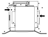
5. Remettez le couvercle de façon à ce que la position des sections (A) et (B) soient inversée par rapport à leur position avant que vous retiriez le couvercle.
