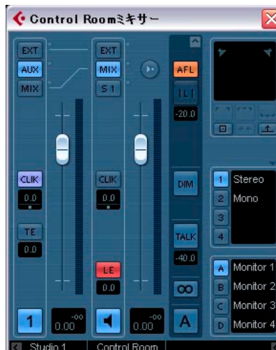
コントロールルーム・ミキサーのスタジオチャンネル - 入力を "AUX" に設定
