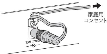
2. 電源ケーブルの電源アダプター側のプラグを、電源アダプターに差し込みます。
